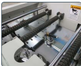
Rouleaux d'entraînement et presseur latéral pour première tête verticale
