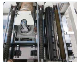
Tête supérieure à couteaux à profils corrugués
