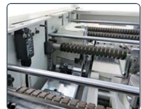
Interrupteur de sécurité pour arrêt immédiat à l'ouverture de la porte
