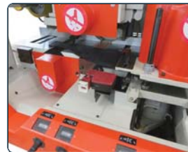
Interrupteur de sécurité avec minuterie coupe-courant à l'ouverture de la porte
