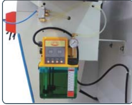
Système de lubrification automatique de la table
