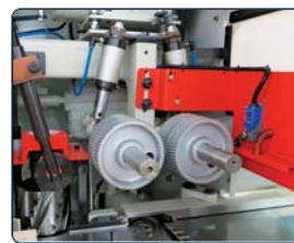
Interrupteur de sécurité à l'entrée pour protection en cas de pièces surdimensionnées
