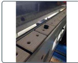
Chaîne d'entraînement avec butées rétractables
