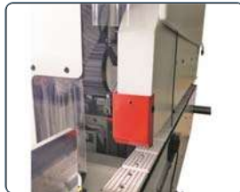
Plaque de sécurité pour arrêt en cas d'alimentation de pièces surdimensionnées
