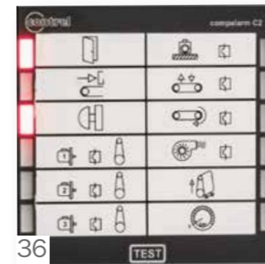
36 Check control Malfunction warning LED Commande LED pour indication des anomalies
