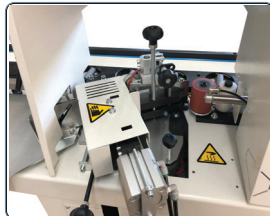
Deux rouleaux de pression et réservoir à colle
