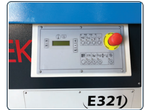
Panneau de contrôle avec PLC intégré
